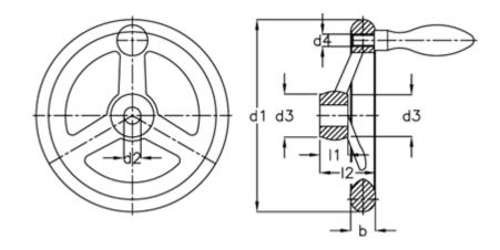
b = 22 d1 = 200 d2 H7 = 22 d3 = 38 d4 = M 10 Handle  $\overline{\phantom{0}}$  = 25 l1 = 24 l2 = 45
